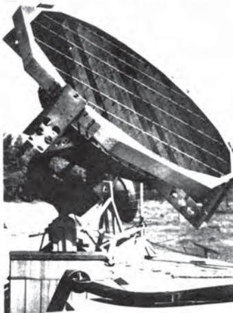
Abb. 17. Teleskop mit  $\lambda$ -Platte für Polarisationsuntersuchungen ( $\lambda = 10,4$  cm) in parallaktischer Aufhängung (Montreal, Kanada).
